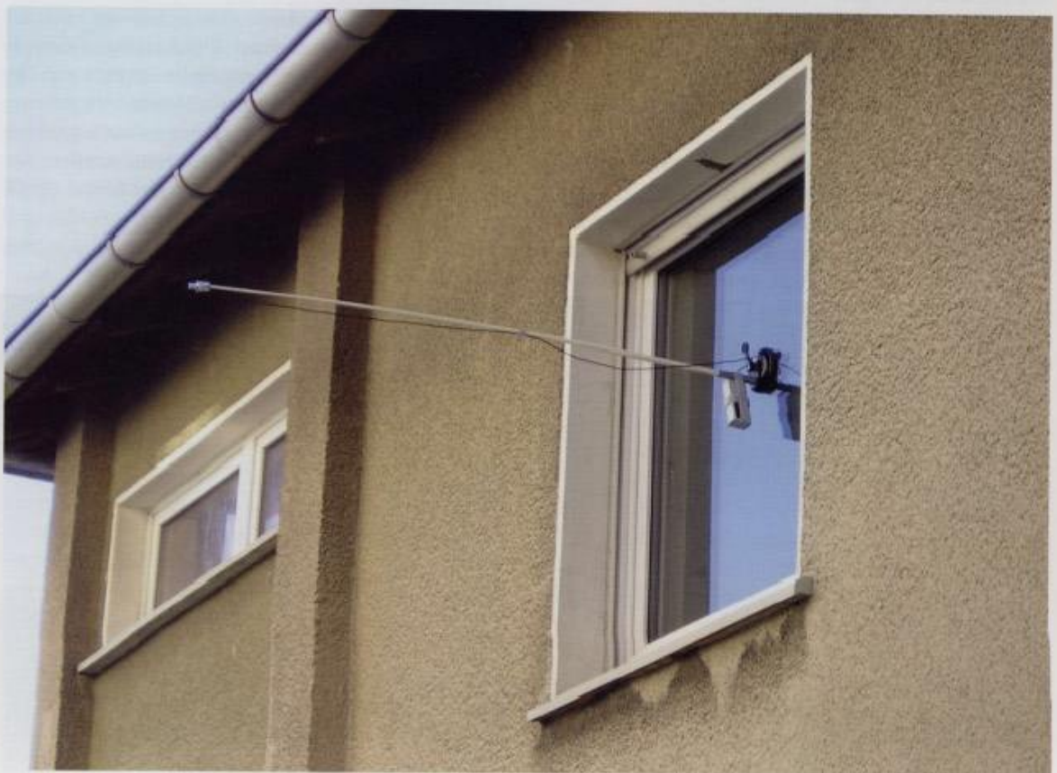
Bild 4-56 An Stellen, die nicht ebenerdig zugänglich sind, kann der Ultraschallsender mit einem Teleskopstab am Gebäude befestigt werden (FCSM)
